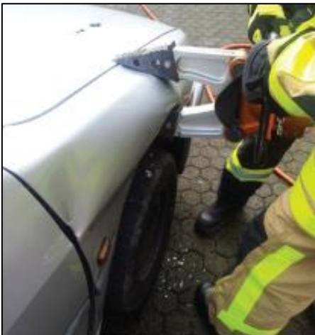
Abb. 19: Zusammendrücken des Kotflügels (Quelle TH VU Ausbildung 2015)
