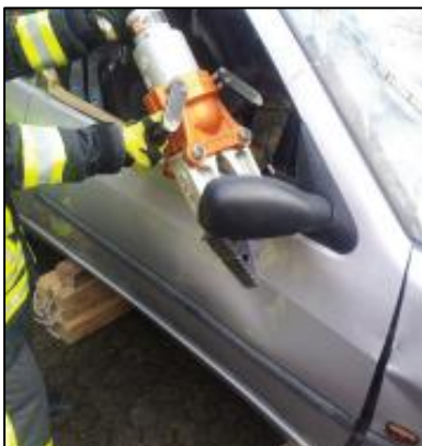
Abb. 21: Zusammendrücken der Fahrzeugtür (Quelle: TH VU Ausbildung 2015)
