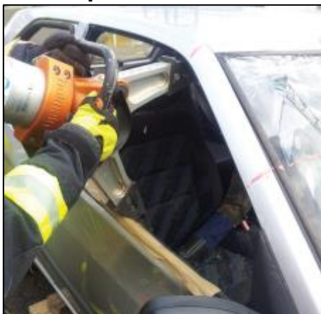
Abb. 20: Spreizer zwischen Dach und Türoberkante (Quelle: TH VU Ausbildung 2015)
